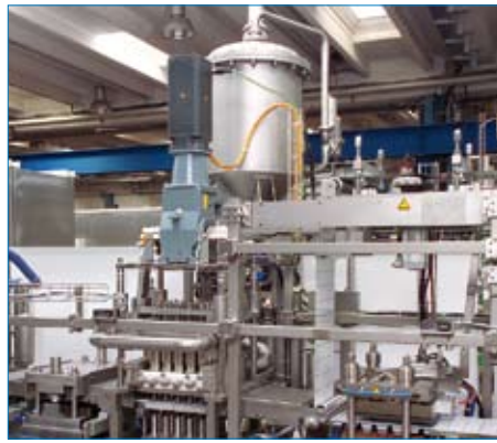
Dosing unit CIP-SIP
